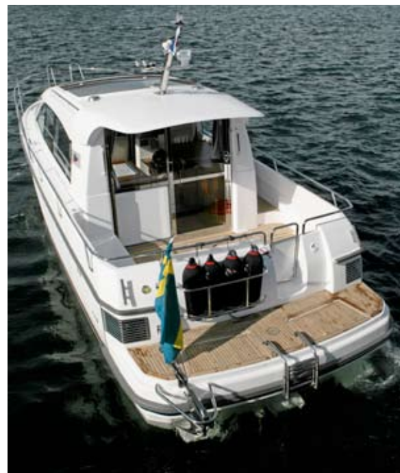
ASENTRISK: Overbygget på Nimbus 365 Coupé er skjøvet over mot babord slik at man får et bredt sidedekk på styrbord side.
